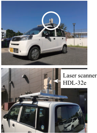
Fig. 2: 実験車両と全方向レーザスキャナ
