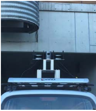
Fig. 2: 3種類レーザスキャナを取り付けた実験車両
