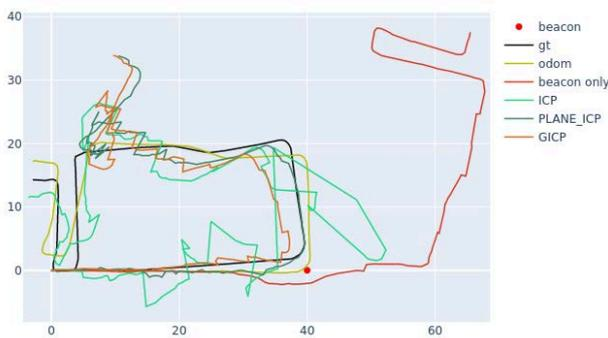
図 7: 各時刻における推定位置のプロット例 車輪オドメトリとビーコンのみを利用した赤線では、推定が大きく外れている
