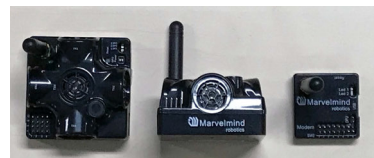
図2: 超音波ビーコン (Marvelmind社製). 左および中央: ビーコン本体. 環境既知点およびロボットに搭載させ、その間の距離を測定する. 右: 環境中のビーコンを制御するモデム.
