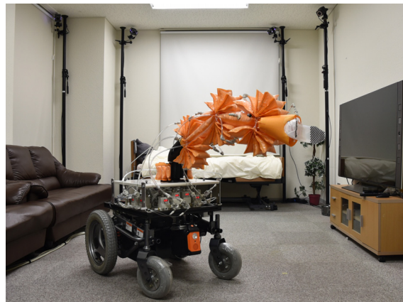
図 1 生活空間と移動型インフレータブルロボットアーム
