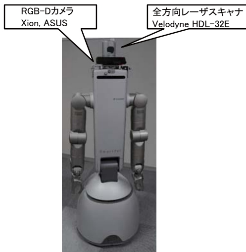
図7 ヒューノイド型サービスロボット (SmartPal V, 安川電機)
