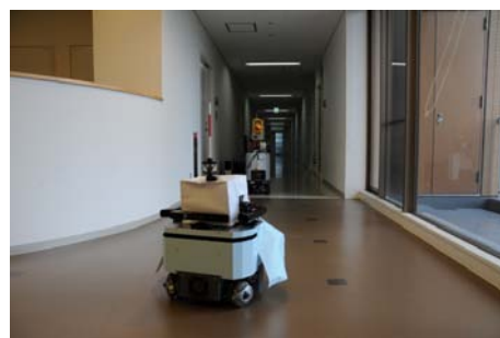
図 11. 全周計測ロボットによる環境形状計測実験の様子
