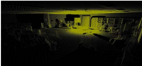
レーザ距離計測装置から得られた 3 次元環境形状
