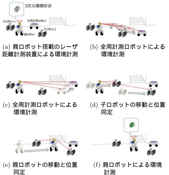
図 6. 全周計測ロボットを加えた CPS-SLAM の計測手順
