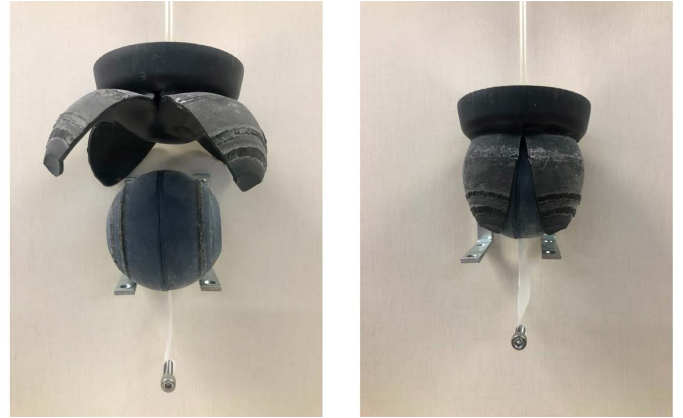
Fig.5 可搬重量測定実験（左：把持前 右：把持後）
