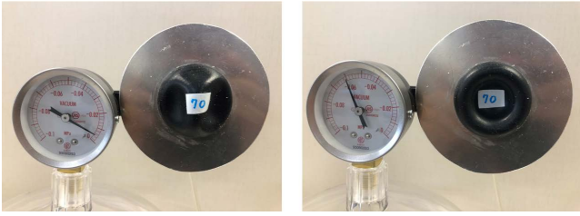
Fig.3 変形時の挙動（左：変形初期 右：変形末期）
