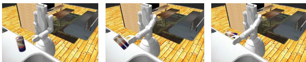
Fig. 5 動力学シミュレータ Gazebo と動作プランナー MoveIt を用いた物品把持シミュレーション
