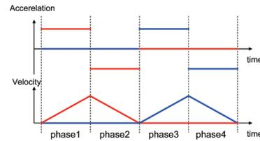
Fig. 9. Walking model (red : right leg, blue : left leg).
