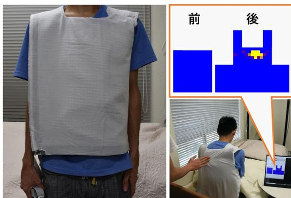
図6 ベスト状ウェアラブル触覚センサの動作実験
