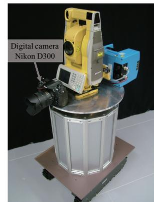
Fig. 14 デジタルカメラ搭載親口ロボット
