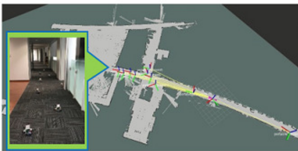
図 12 ポータブル GO により計画された車いすロボットの移動経路
