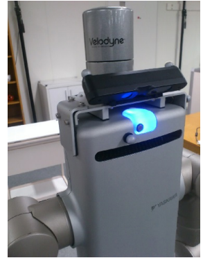
図 2 HDL-32E の装着状況
