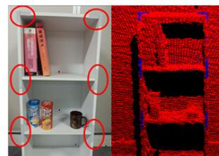
図3 棚枠の反射材
