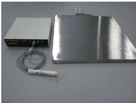
Fig.4 磁気式 3次元位置姿勢センサ Microbird (Model 180, Ascension Technology Co., USA)
