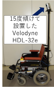
Fig.6 Velodyne HDL-32e を 15 度傾けて搭載した移動ロボット
