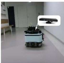
図6 RGB-D カメラ (Kinect) を搭載した移動ロボット [18]
