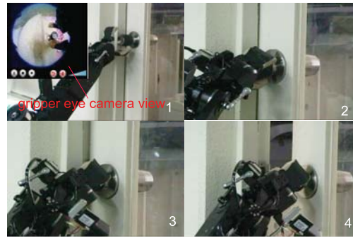
Fig. 12. Door opening tests
