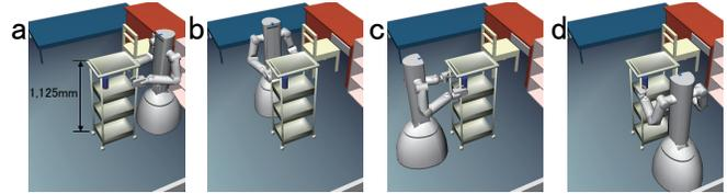
Fig. 2. Candidate points for wagon gripping position: (a)  $i=0$ , (b)  $i=1$ , (c)  $i=2$ , (d)  $i=3$ .
