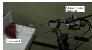
図 14 ナビゲーションシステムを用いた実験風景 Fig. 14 Experimental setup for evaluation of the surgical navigation system.
