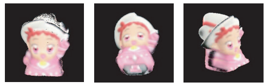
図 13 3 次元モデルへのカメラ画像のマッピング Fig. 13 An example of mapping the camera image on the 3D model.
