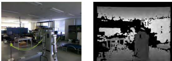
図 1 Kinect から得られる RGB 画像と距離画像の一例
