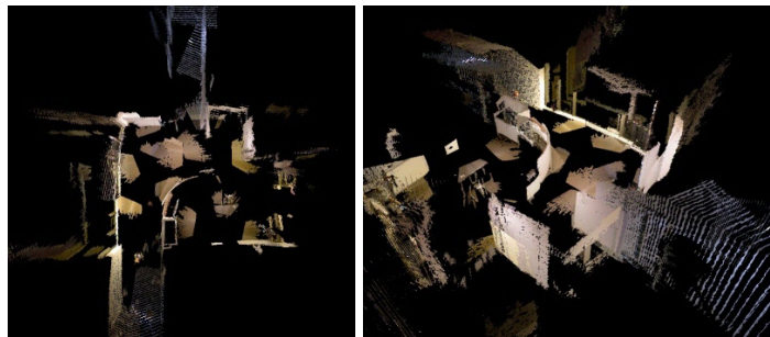
図 19 . 計測ロボットから得られた 3 次元環境形状
