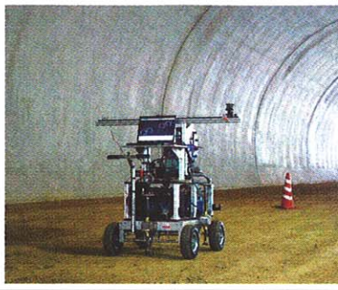
移動式の3次元形状計測装置
